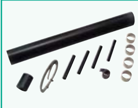
Termoskrčljivi set za izolacijo nizkonapetostnih 0.6/1 kV-nih vodnikov, zaščitenih s trakom 8
